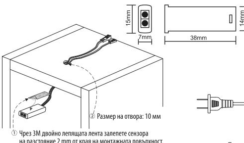
① Чрез 3M двойно лепящата лента запелете сензора на разстояние 2 mm от края на монтажната повърхност.
